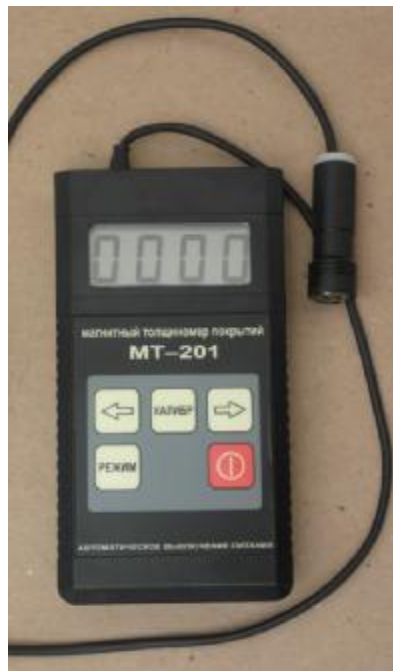
Рисунок 2. Внешний вид толщиномеров покрытий магнитных МТ-201
