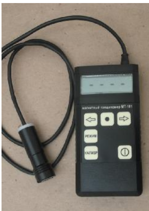
Рисунок 1. Внешний вид толщиномеров покрытий магнитных МТ-101
